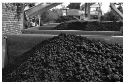
Entwässerter Klärschlamm auf der Kläranlage Silstedt
