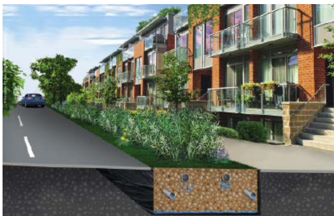
Abb. 1: Energieallee: Mehrfachnutzung der urbanen Fläche zur Wasseraufbereitung, Wasserspeicherung und Bereitstellung von Ökosystemdienstleistungen (Quelle: Fraunhofer ISI)
