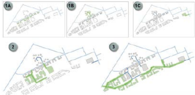
Abb. 3: Etappenweise Erschließung einer Konversionsfläche für die Trinkwasserversorgung (grün = geplante Trinkwasserleitungen, blau = bestehende oder neu errichtete Trinkwasserleitungen) (Quelle: IWW)
