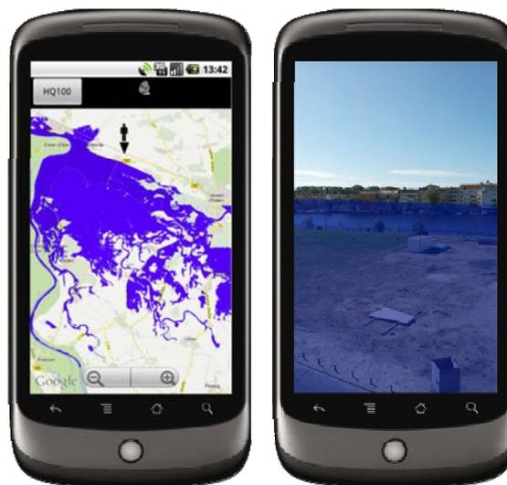
Abb. 2: Hochwassergefahrenkarte in Kartenansicht (links) und in Kameraansicht als AR (rechts)
