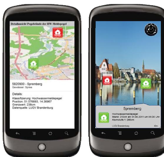
Abb. 3: Hochwassermeldepegel auf Karte (links) und in Kamera als AR (rechts)
