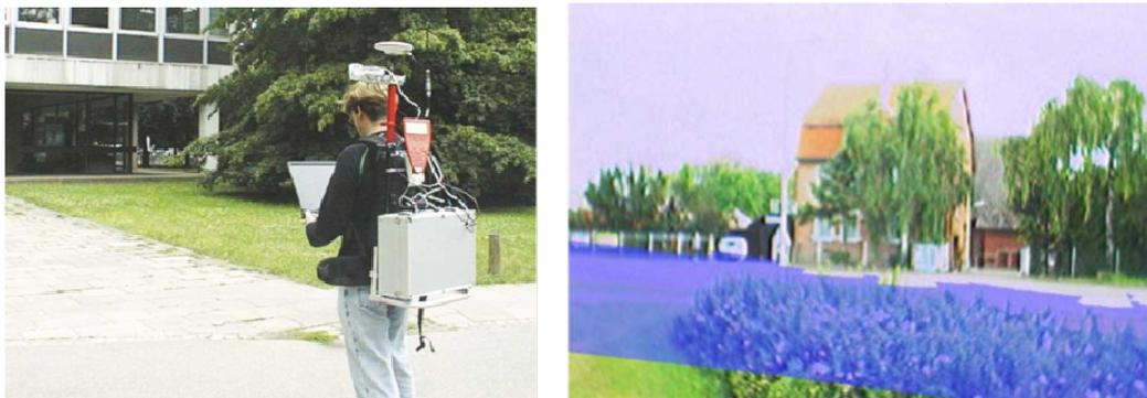
Abb. 1: mAR-System zur Visualisierung von Hochwasserereignissen (Coelho, 2004)
