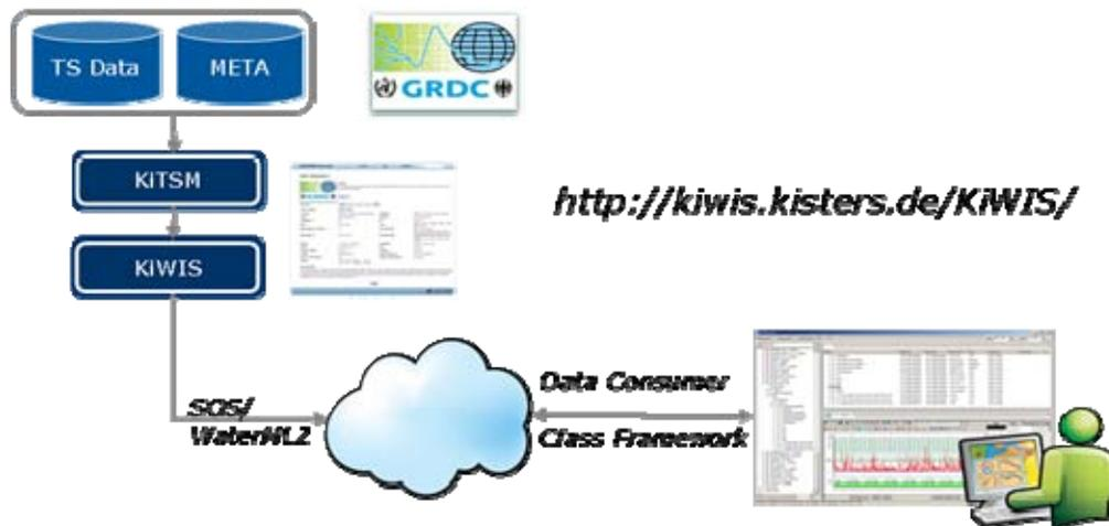
Abb. 4: Datenfluss mittels SOS/WaterML2 im IE3 über den Businesslayer KiTSM und das WebService-Interface KiWIS zum OGC kompatiblen Client
