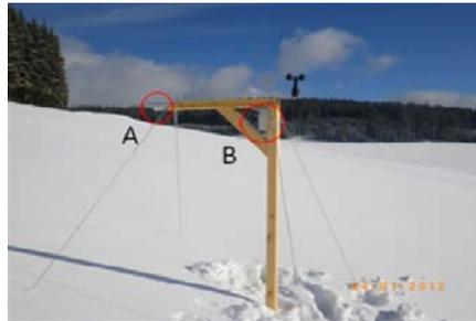
Abb. 1.: SnoMo-Station mit Sensoreinheit (A) , Loggereinheit (B) und Windmessung
