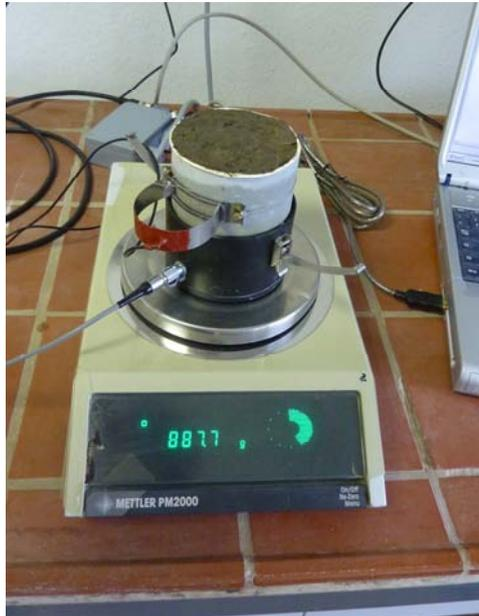
Abb. 2: HYPROP verändert zur Schrumpfungsmessung.
