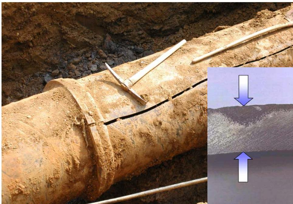
Abb. 21: Rohrschaden einer GG-Leitung DN 900 mit Vorschädigung durch Spongiose (Bildausschnitt)
