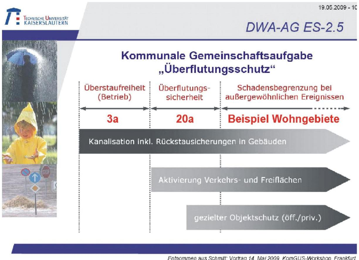
Abb. 6: Konzept zur Überstau- und Überflutungssicherheit bei dem Bau von neuen Anlagen am Beispiel von Wohngebieten (SCHMITT 2009)
