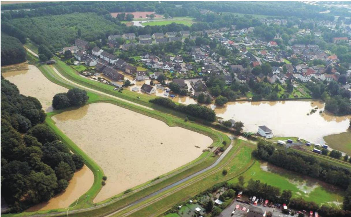
Abb. 5: Luftbild „Polder Marten“ am 27.07.2008. Im Vordergrund das Regenrückhaltebecken 6.23 (links) und das HRB "Bärenbruchgraben". In der oberen rechten Bildhälfte befindet sich der teilweise überflutete Ortsteil Marten.
