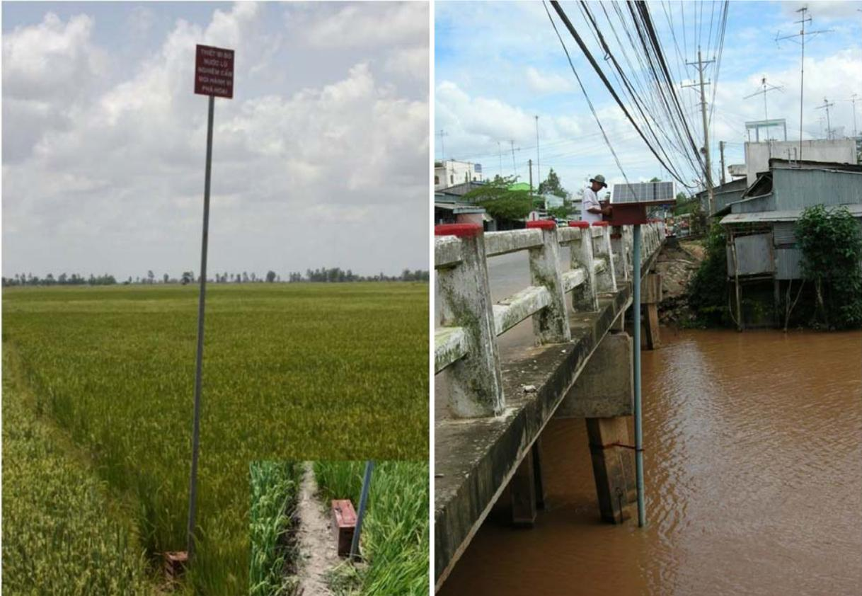
Abb. 3: Wasserstandsstation in den Überflutungsflächen (links) und eine Trübungsstation im Kanal (rechts)
