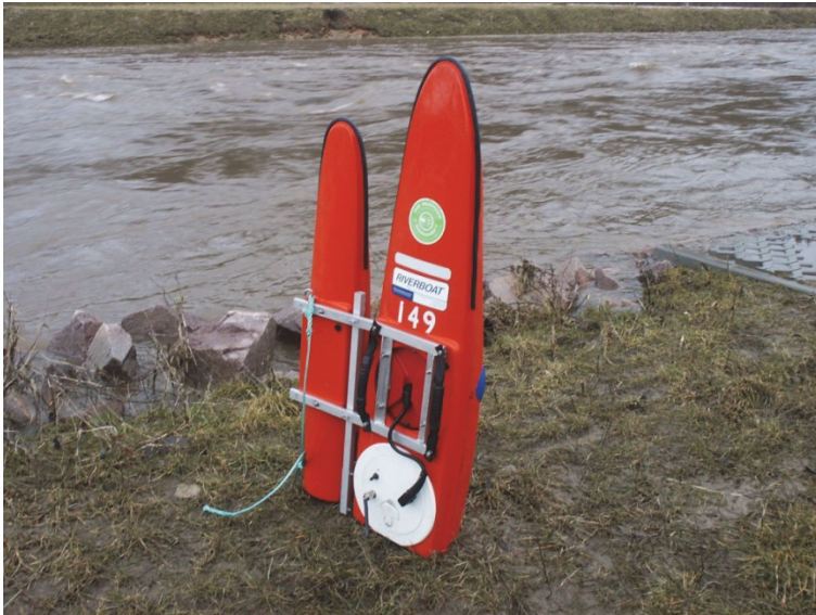
Abb. 1: Am Pegel Mahlitzsch durch Treibgut zerstörter Messgeräteträger mit Rio Grande Messkopf.
