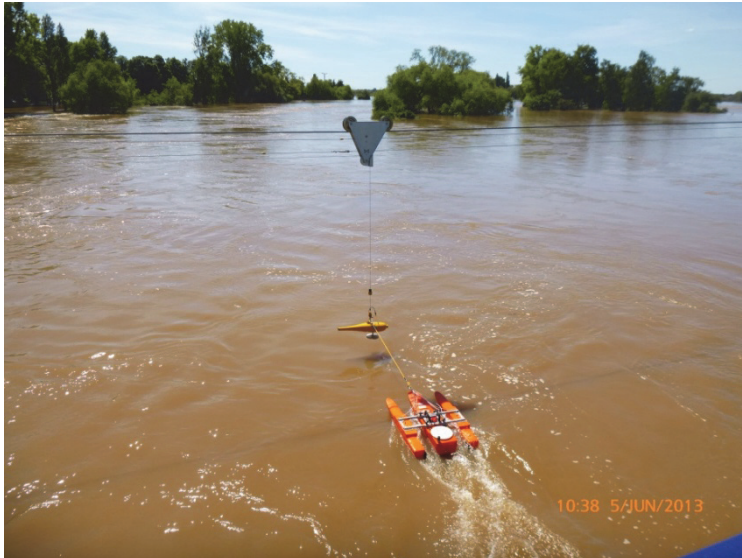
Abb. 2: Durchflussmessung am Pegel Bad Düben am 05.06.2013.
