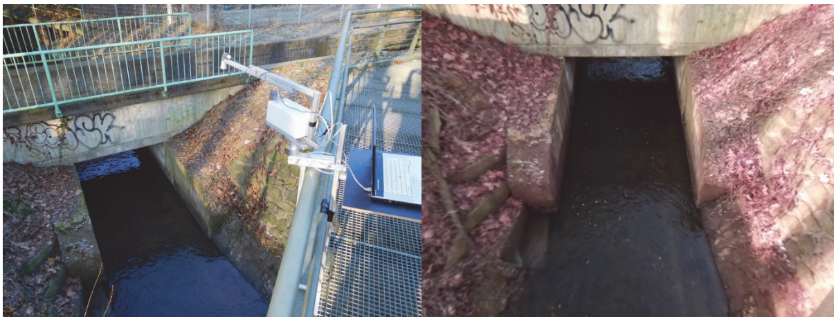
Abb. 5: Aufbau des Messgeräts am Flehbach in Köln mit Blick in Fließrichtung (links); Roh-Einzelbild aus Messaufnahme, Blick in Fließrichtung (rechts).
