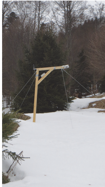
Abb. 4: Im Gebiet installiertes SnoMoS – System. Die Schneehöhe wird durch einen Ultraschallsensor am Ende des Auslegers erfasst.
