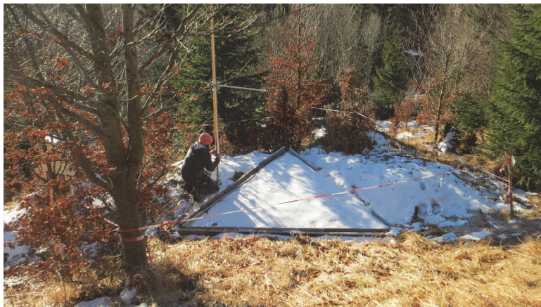
Abb. 3: Messaufbau des Schneelysimeters auf einer Freifläche im Gebiet.
