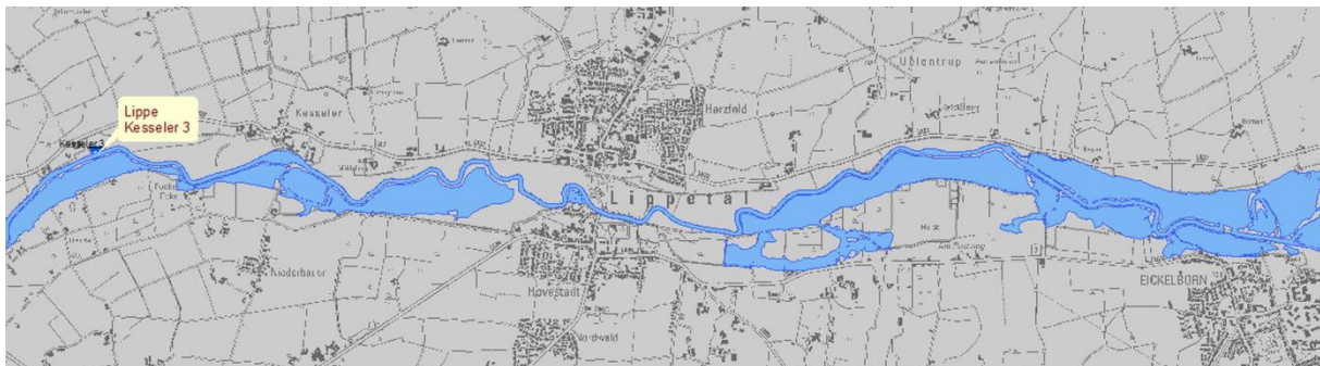
Abb. 6: Überflutungsflächen der Lippe beim MHQ, 2D-Berechnung unter Berücksichtigung der submersen Vegetation
