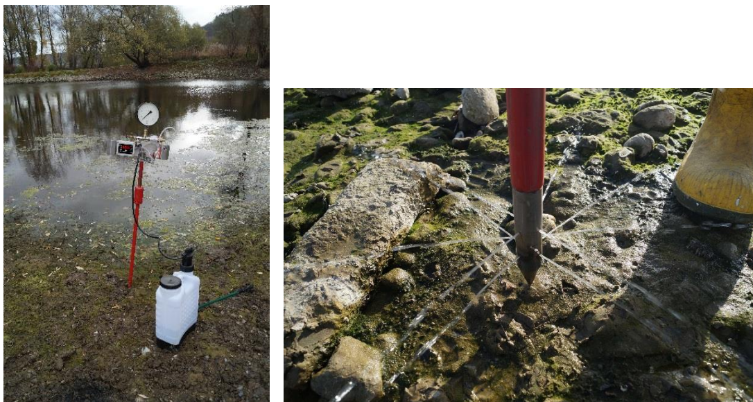
Abb. 4: Links: Prototyp 1 mit Druckanzeige und Messeinheit, rechts: Perforierte Spitze beim Messen „an Luft“.
