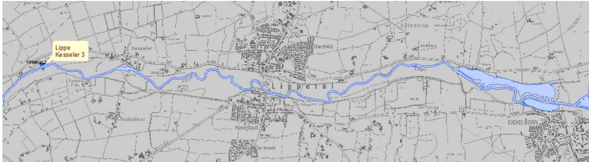
Abb. 5: Überflutungsflächen der Lippe beim MHQ, 2D-Berechnung ohne Berücksichtigung der submersen Vegetation
