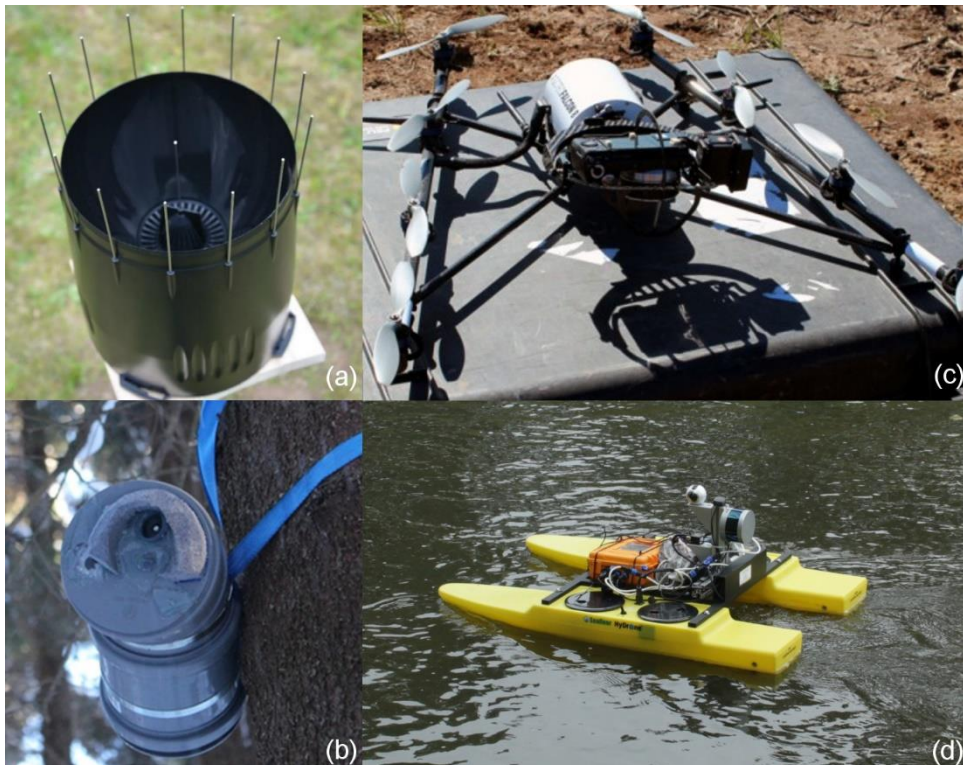
Abb. 3: Verwendete Sensorsysteme: (a) low-cost Regenmesser, (b) low-cost Kamerapegel, (c) UAV für Luftbildaufnahmen, (d) Bootplattform für Aufnahmen auf dem Wasser.
