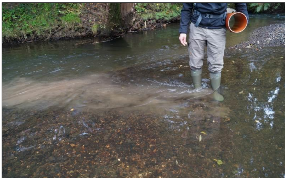
Abb. 3: Hinweis auf Kolmation: Feinsedimentfahne bei Lösen der Deckschicht durch Betreten der Gewässersohle.
