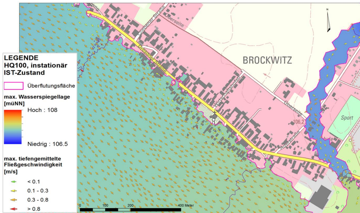
Abb. 7: Maximale Wasserspiegellagen, Überflutungsflächen und tiefengemittelte Fließgeschwindigkeiten für instationäre Berechnung mit HQ100, Ist-Zustand
