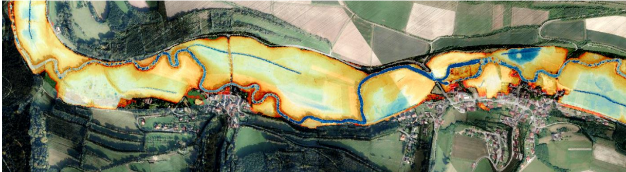
Abb. 3: Tiefenabhängige Analyse des digitalen Geländemodells am Weißen Main zur Ermittlung rezenter Fließgerinne und potentieller Feuchtestandorte [maßstabslos]
