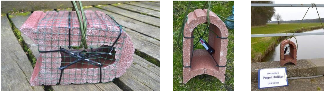
Abb. 2: Installation der Datenlogger im Gewässer (links und Mitte: handelsübliche Pflanzsteine als Einhausung und Verankerung, rechts: Einsetzen der Messgeräte ins Gewässer am Pegel Hollige).
