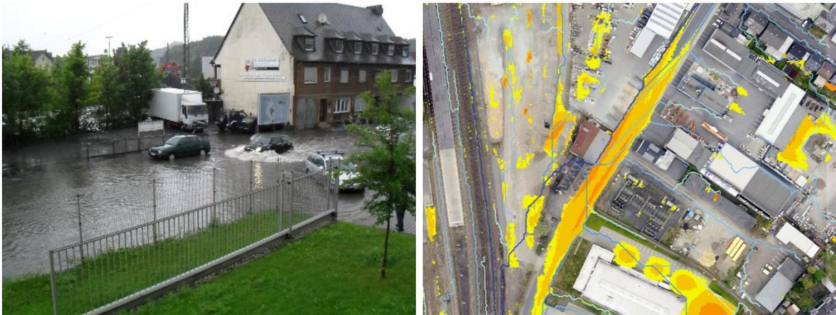
Abb. 2: Ein Starkregenereignis am 29.06.2012 führte u. a. zur Überflutung eines in einer Senke gelegenen Straßenbereiches in Siegen (links, wirSiegen.de 2012). Die Geländesenke konnte im Rahmen der GIS-basierten Analysen ebenfalls ermittelt werden und weist mehrere Fließ- bzw. Zuflusswege auf (rechts, Bildmitte).
