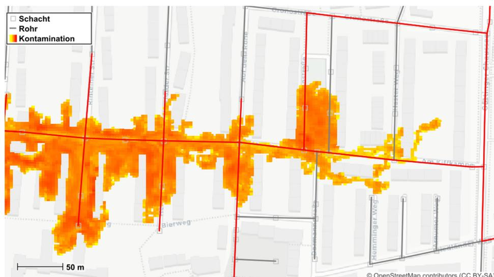
Abb. 6: Ausbreitungsgebiet eines Schadstoffeintrags. Kontamination der Kanalrohre durch Rotfärbung gekennzeichnet. Gradient der Oberflächenfärbung von gelb (schwach) bis rot (stark kontaminiert)
