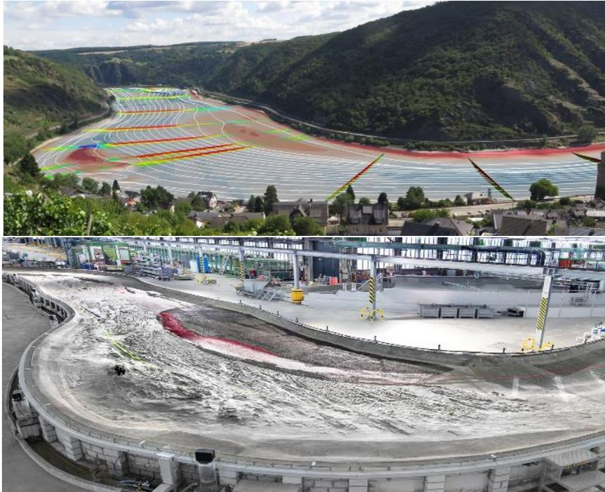
Abbildung 1: Ergebnisse aus dem numerischen Modell (oben) und Bild des gegenständlichen Modells (unten) vom Rheins am schiffahrtlichen Engpass Jungferngrund
