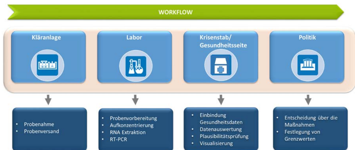
Abbildung 2: Arbeitsschritte des Abwassermonitorings
