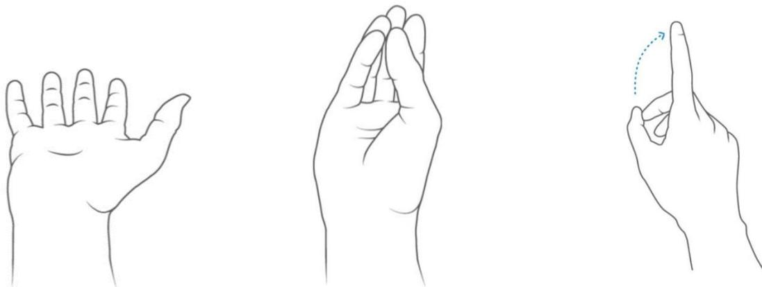
*Abbildung 2: Gesten zu Bedienung der AR/MR-Brille Microsoft HoloLens (Links und Mitte: sog. Bloom-Geste zur Öffnung des Menüs; Rechts: sog. Air-Tap-Geste bzw. in die Luft-Tipp Geste zur Auswahl einer Anwendung)*
