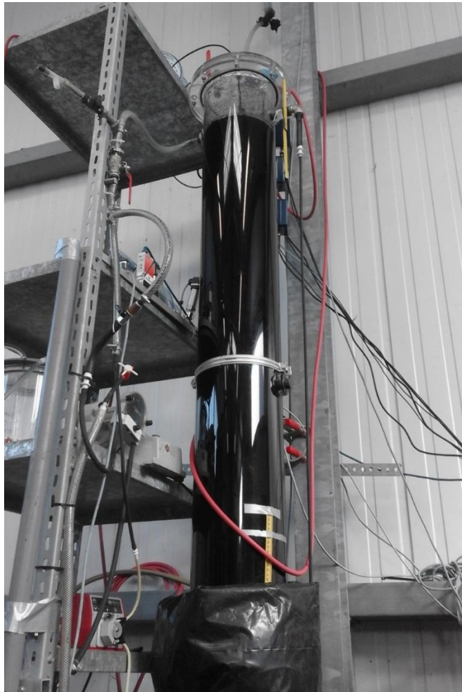
Bild 12: Versuchsaufbau zu Wasserstoffeintrag mit Faulschlamm
