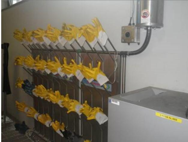
Beispiel: Trocknungsanlage für gereinigte Handschuhe (Quelle: BWB)
