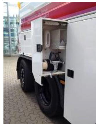
Beispiele Handwaschanlage an Kanalreinigungsfahrzeugen (Quelle: SEBD, BWB)
