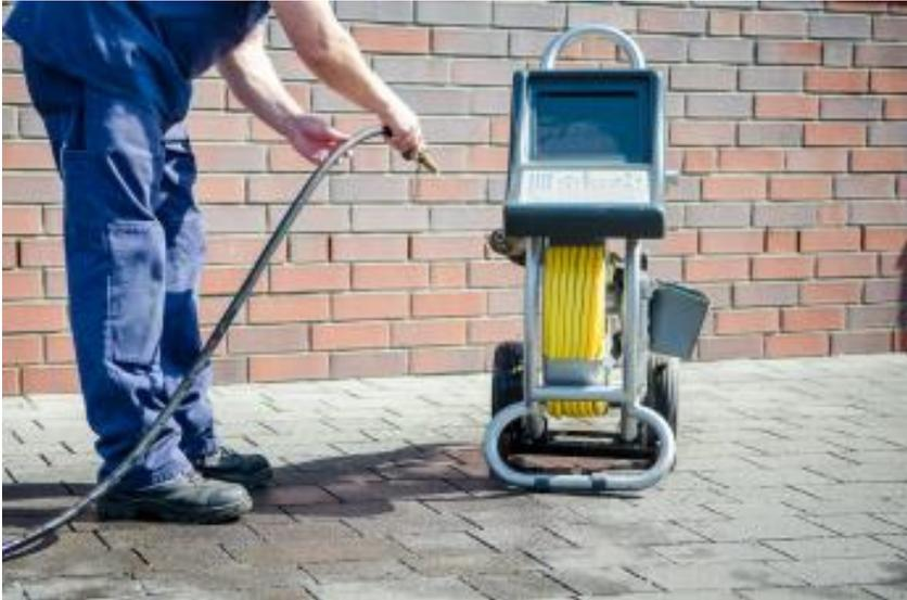
Reinigung Hausanschlusskamera (Quelle: BWB)
