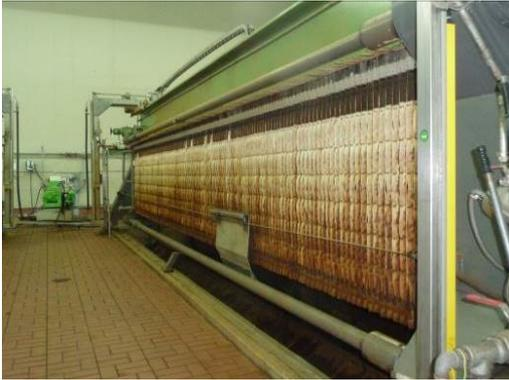
Beispiele: Automatische Reinigung Kammerfilterpresse
