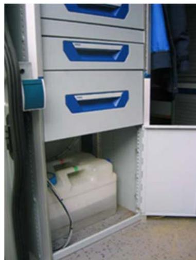
Beispiel: In ein Schubfach integriertes Waschbecken, darunter der Frischwasserkanister (Quelle: Ruhrverband)
