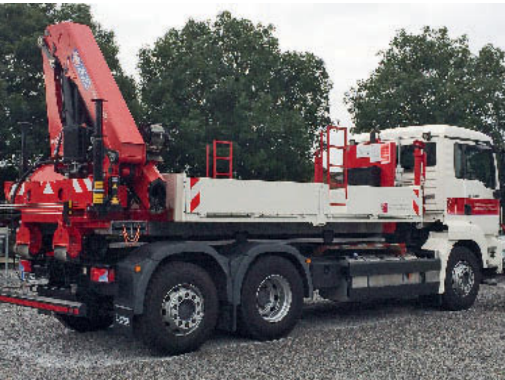
Der Abrollkipper mit Kran ist eine Spezialanfertigung: Wird der Aufbau (Ladefläche mit Kran) abgesetzt, lässt sich das Fahrzeugchassis anderweitig nutzen. Die vielfältigen Einsatzmöglichkeiten wurden im Ausschreibungsprozess berücksichtigt und im Hinblick auf Arbeitsschutzbestimmungen geprüft.
