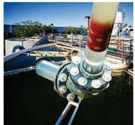
Versuchsaufbau: Der Molch hat die Aufgabe, mechanisch Ablagerungen von den Rohrwänden zu lösen.
