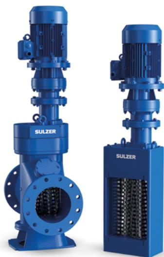
Abb. 1: Die Muffin Monster™ sind kompakte und robuste Zerkleinerer für Anwendungen im Schlamm- und Abwasserbereich. Der maximale Durchfluss liegt bei 1558 m<sup>3</sup>/h, der maximale Betriebsdruck bei der Gleitringdichtung beträgt 10,3 bar. Der Zulauf erfolgt über eine Rohrleitung (links) oder über einen offenen Kanal (rechts). Für größere Durchflussleistungen passt die Baureihe Channel Monster™ mit bis zu 9300 m<sup>3</sup>/h.
