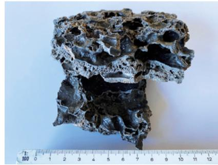
Abb. 7: Das war einmal ein Stück eines Kunststoffrohrs (Detailaufnahme des thermisch veränderten Rohrmaterials)
