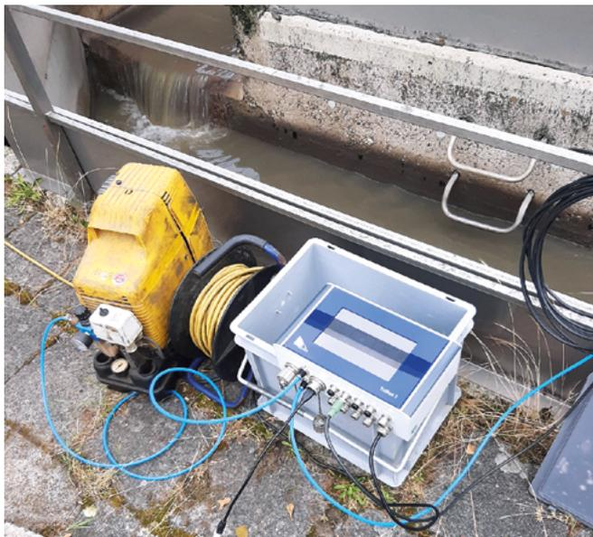
Abb. 2: Die Geräteeinrichtung der Messstelle am Ablauf der Vorklärung, von links: kleiner Kompressor für die Impulsreinigung des Sensorkopfes, Kabeltrommel und die blaue Box als Auswertegerät
