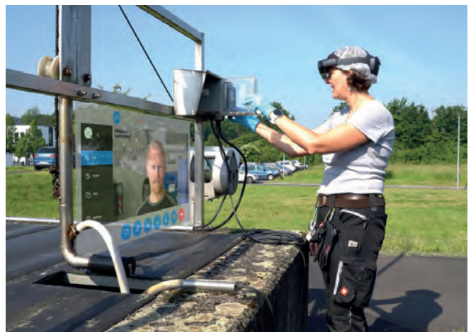
Einsatz einer Datenbrille auf einer Kläranlage (Foto: Kläranlage Hennef / SBG Dresden)
