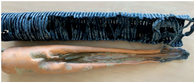
Abb. 1: Zwei ausgegrabene, verschmorte Rohstücke
