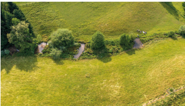
Bild: 5 Beaver Dam Analogs in Funktion, Projekt Schlossbach. Drohnenaufnahme der Einstau- und Zwischenbereiche (Foto C. Angst).
