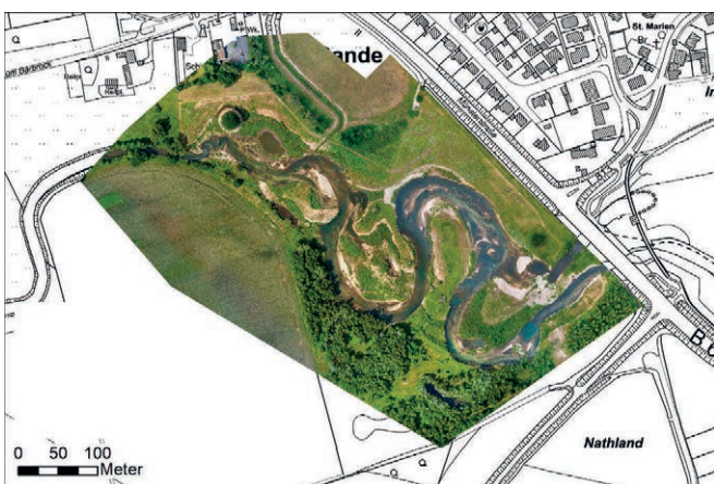
Bild 3: Georeferenziertes Luftbild des Renaturierungsbereichs der Lippe in Paderborn-Sande, aufgenommen am 12. Juni 2024, eingebunden in ArcGIS. Hintergrundkarte: Land NRW (2024), Datenlizenz Deutschland – Namensnennung – Version 2.0 (www.govdata.de/dl-de/by-2-0)
